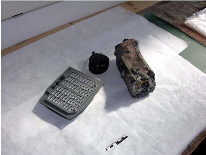
Warnlampenkonsole (Neuteil), verbrannter Fahrtmesser, durch Aufprall zerstörter Höhenmesser
